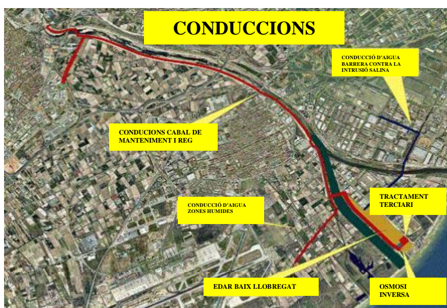
Figura 7. Plano de las instalaciones de reutilización
