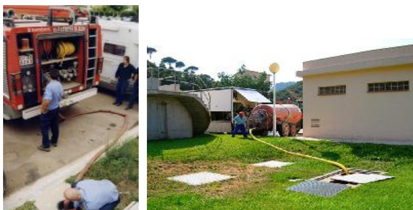
Figura 8. Dues imatges dels usos no potables en municipis de la Costa Brava nord. Esquerra: Bombers carregant a l'hidrant de l'EDAR de Port de la Selva, estiu de 2003. Dreta: Camió cuba carregant al dipòsit d'aigua regenerada de l'EDAR de Portbou, per a l'ús en la construcció de la nova carretera, 30 de juny de 2005.
