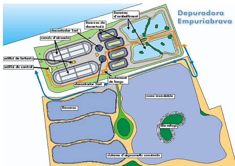
Figura 1. Vista general de la EDAR y del sistema de humedales construidos de Empuriabrava.
